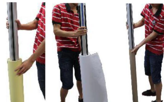
5. Umieść rolkę laminatu na wałku zdawczo-odbiorczym, podkład na wałku górnym, grafikę na wałku pod stołem zdawczym. Zmierz pozycję wszystkich rolek za pomocą skali i miar na wałkach. (Patrz diagram na maszynie)
