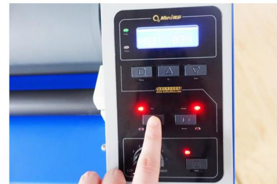
17. W trybie „do przodu” naciśnij RUN aby laminować i dostosuj prędkość potencjometrem.
