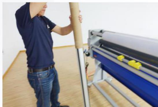
5. Umieść rolkę laminatu na wałku zdawczo-odbiorczym, podkład na wałku górnym, grafikę na wałku pod stołem zdawczym. Zmierz pozycję wszystkich rolek za pomocą skali i miar na wałkach. (Patrz diagram na maszynie)
